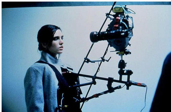
**Figure 3** – Appareil de type « snorricam » utilisé pour le tournage du film *Requiem for a dream* (Darren Aronofsky, 2000)
